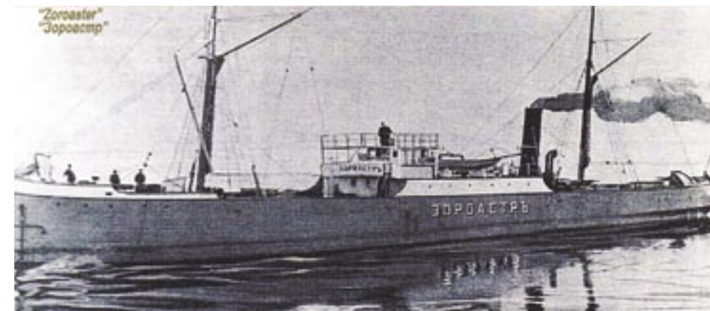
Первый в мире паровой танкер для перевозки нефти «Зороастр», построенный в 1877 году по заказу Людвиг Нобеля. Фото предоставлено с любезного разрешения Азербайджанского Национального Архива и Института Истории Нефти.
